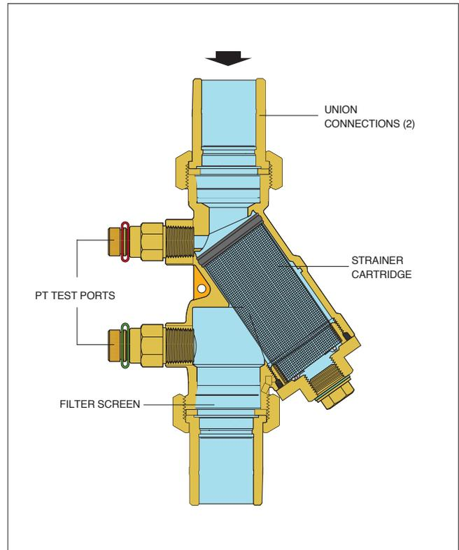
**NPT Y-STRAINERS FOR PLUMBING AND HYDRONICS**
